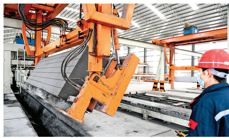
项目利用开发区内钢铁企业脱磷石膏、粉煤灰、湿排灰为主要原料,生产蒸压砂加气块及加气混凝土板材,实现固废资源综合高效循环利用,变废为宝,为推动开发区经济高质量发展注入新动能。
