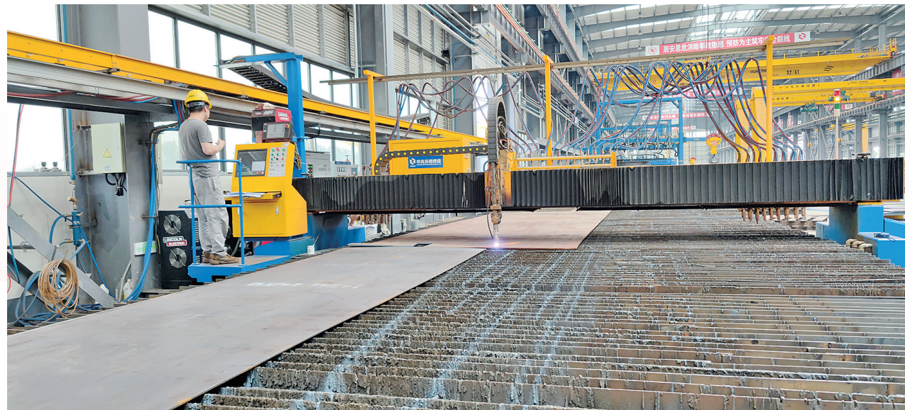
8月4日，工人在制桥生产线上根据设计图纸裁切钢板。
