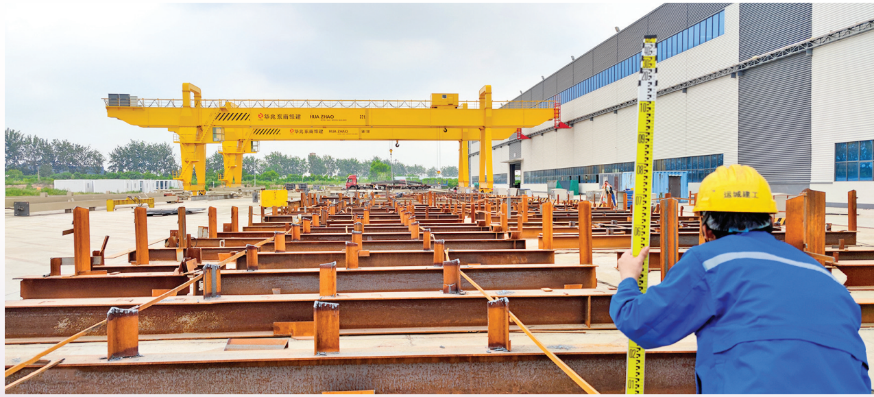
8月4日，工人在制桥车间外，根据客户不同的要求对胎架进行改造再利用。
