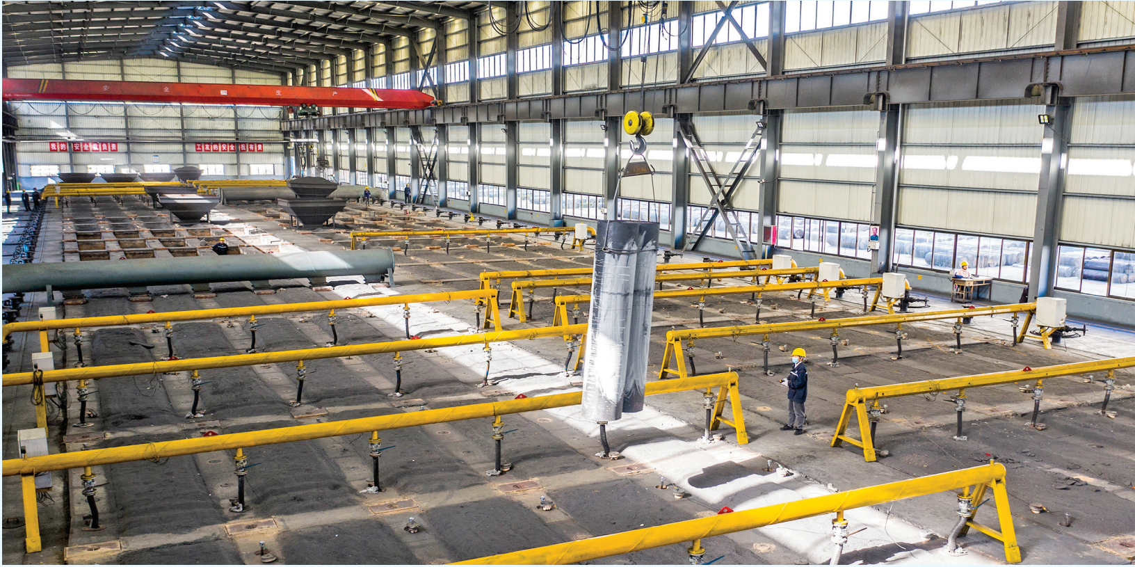
山西北都碳材料有限公司生产车间内，待焙烧的石墨电极被天车吊起，等待进入焙烧炉内 本报记者 金玉敏 摄
