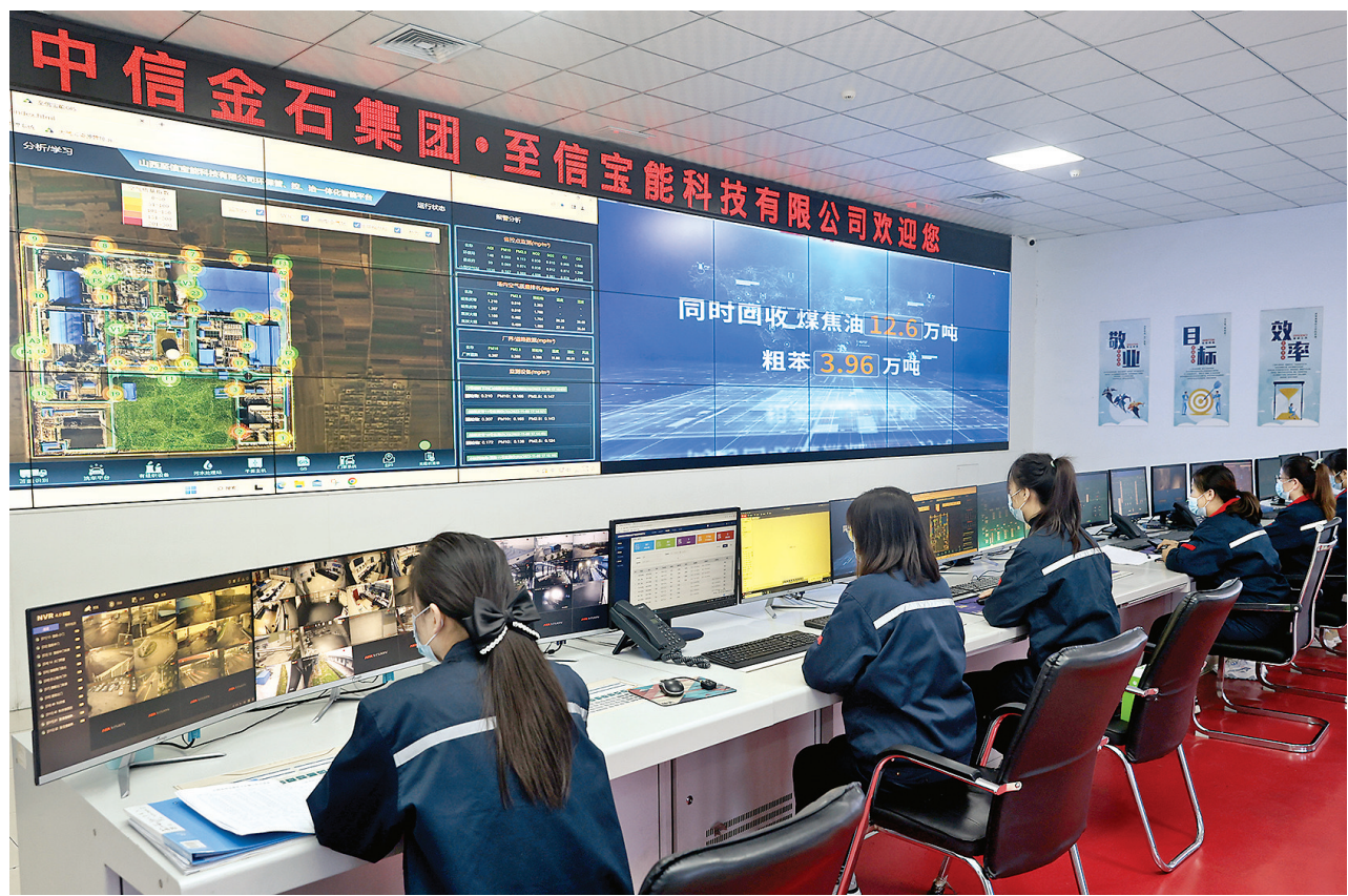
11月14日，山西至信宝能科技有限公司中控室技术人员在监控各种自动化生产数据。该公司属于全省转型升级的重点项目，近年来累计投资15亿元，建设了年产量150万吨工艺技术先进的炭化室大型捣固焦炉，节能降耗值低于国家标准13%，烟气脱硫脱硝达到国家超低排放标准，工业废水全部实现回收利用。
