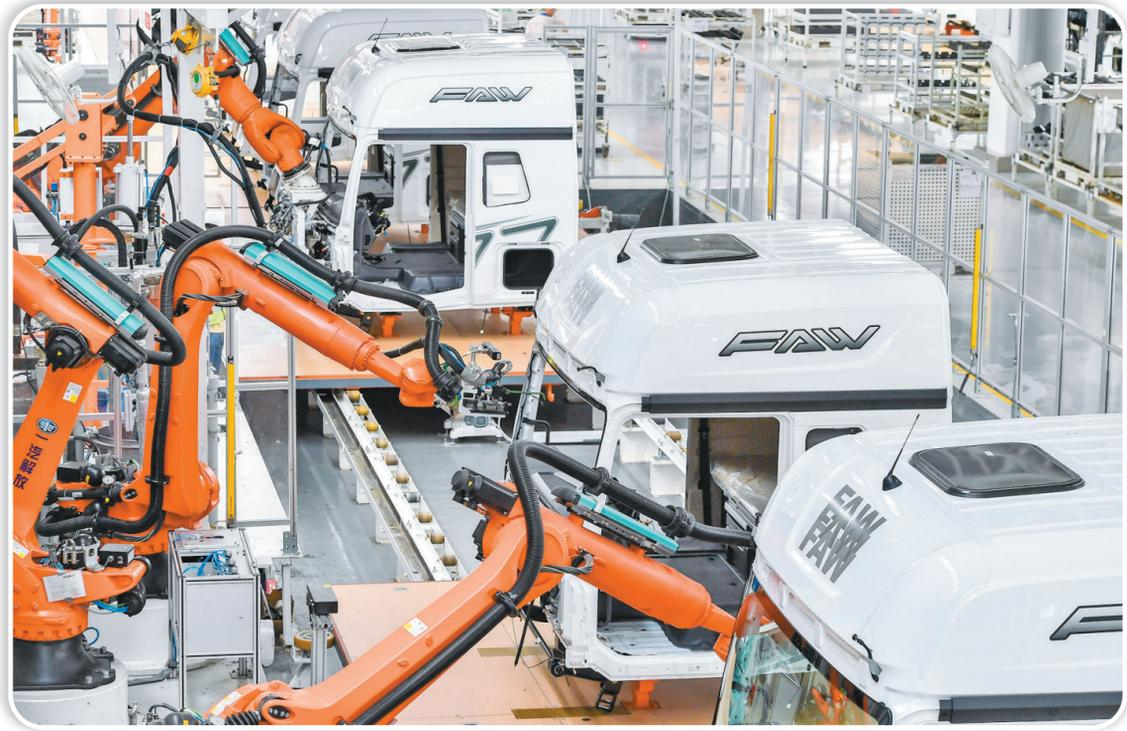
▲近日，在位于吉林长春的一汽解放J7智能工厂内，智能机器人进行车辆玻璃装配及涂胶工作。
