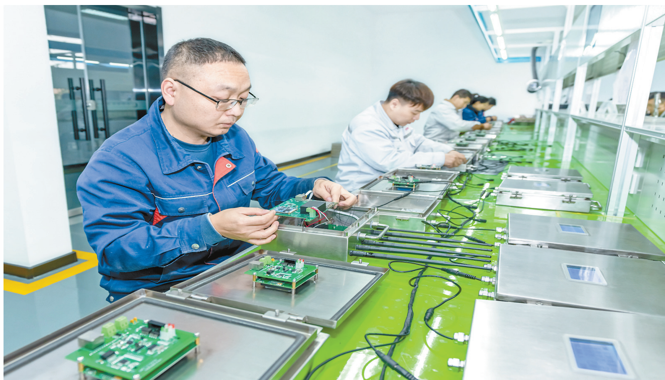
▲山西宏安翔科技股份有限公司技术人员在调试矿用5G顶板智能监测分站产品。
