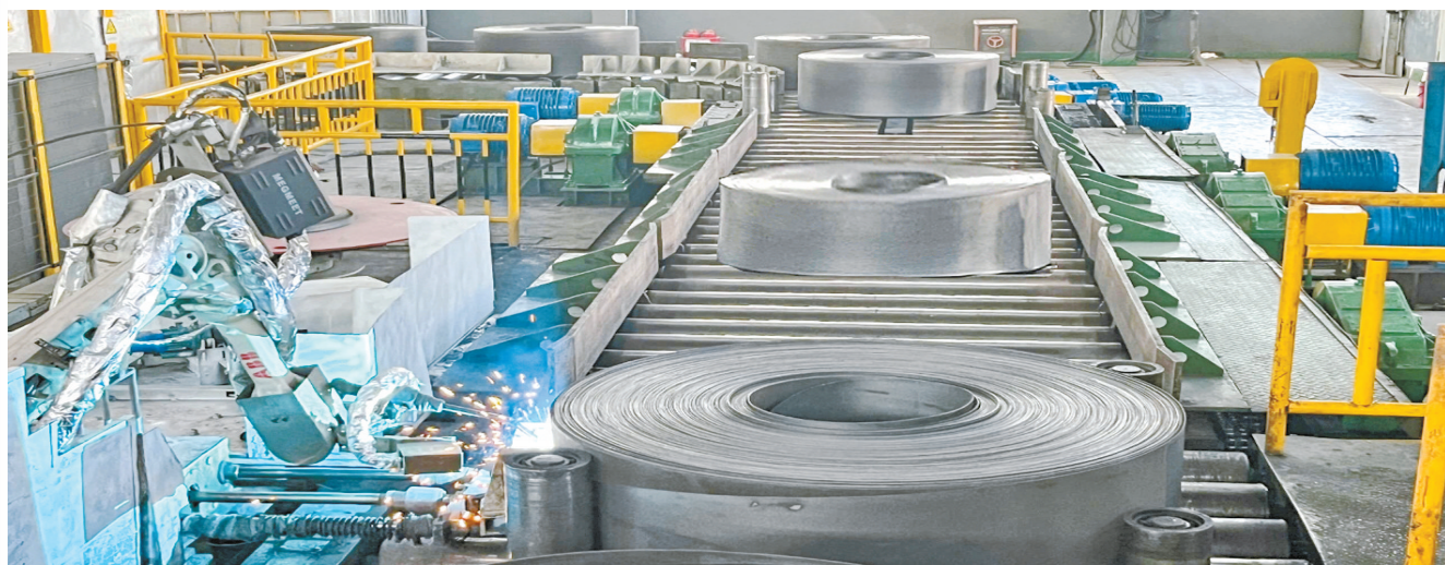
▲山西建龙实业有限公司的智能焊接机器人,自动焊接热轧卷板。
