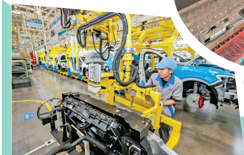
下图:在大运新能源汽车总装车间内,技术人员正在组装新能源汽车,确保订单高质量如期交付。
