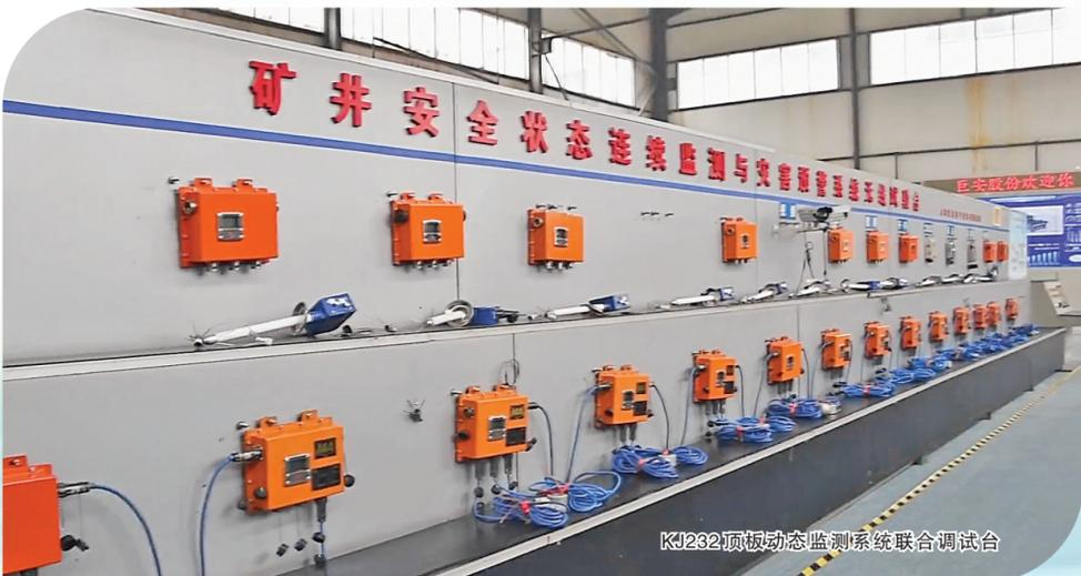
KJ232顶板动态监测系统联合调试台
