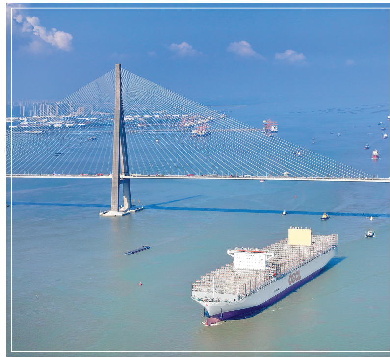
▲8月30日,超大型集装箱船“东方葡萄牙”轮通过江苏苏通长江大桥。当日,在边检、海事等部门的保障下,超大型集装箱船“东方葡萄牙”轮顺利离开长江南通段水域,前往相关海域试航。据悉,该船由南通中远海运川崎船舶工程有限公司自主研发设计建造,船长399.99米、型宽61.3米、型深33.2米,可装载24188个国际标准集装箱。
