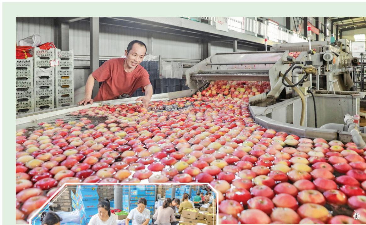
图① 皓美公司出口水果分选包装车间,智能化果品分选设备在自动清洗苹果。
