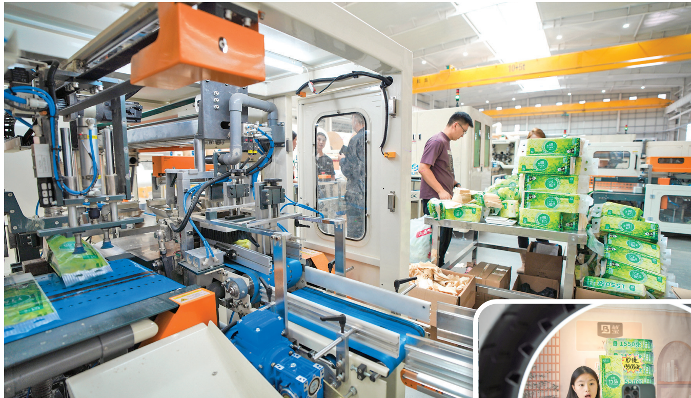
▲源泰热能有限公司纸加工车间内,自动包装机正在生产小包抽纸。
