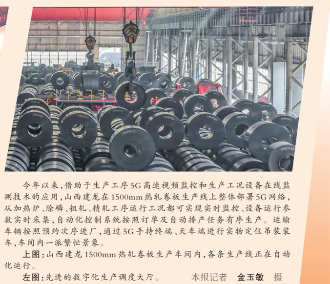
今年以来，借助于生产工序5G高速视频监控和生产工况设备在线监测技术的应用，山西建龙在1500mm热轧卷板生产线上整体部署5G网络，从加热炉、除磷、粗轧、精轧工序运行工况都可实现实时监控，设备运行参数实时采集，自动化控制系统按照订单及自动排产任务有序生产。运输车辆按照预约次序进厂，通过5G手持终端、天车端进行实物定位吊装车，车间内一派繁忙景象。
