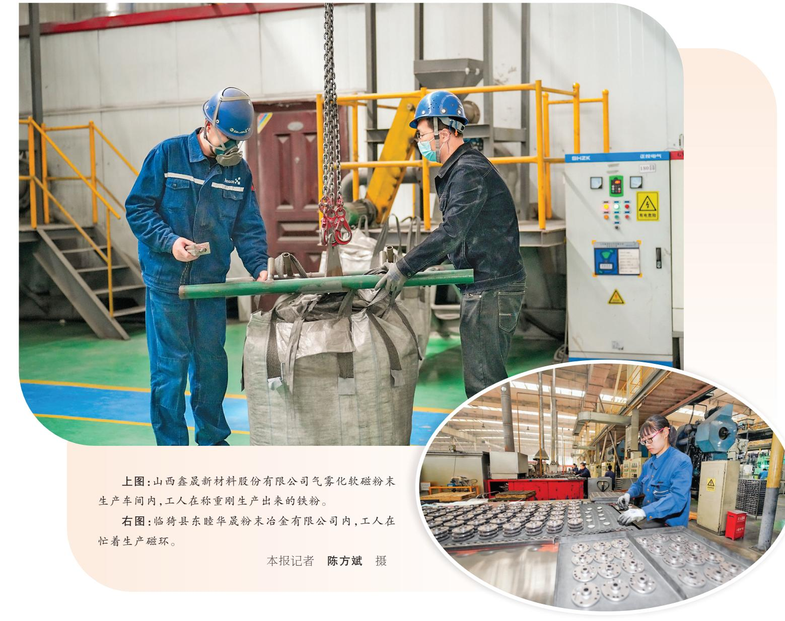
上图:山西鑫晟新材料股份有限公司气雾化软磁粉末生产车间内,工人在称重刚生产出来的铁粉。
