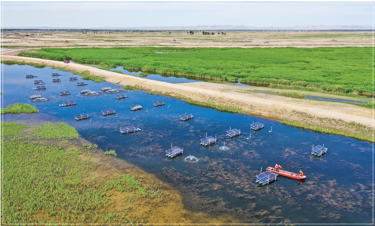
6月4日，在乌拉特前旗九排干人工湿地，太阳能曝气机对进入乌梁素海的水体曝气增氧（无人机照片）。位于内蒙古巴彦淖尔市乌拉特前旗的乌梁素海是黄河流域最大的湖泊湿地，承担着黄河水量调节、水质净化、防
