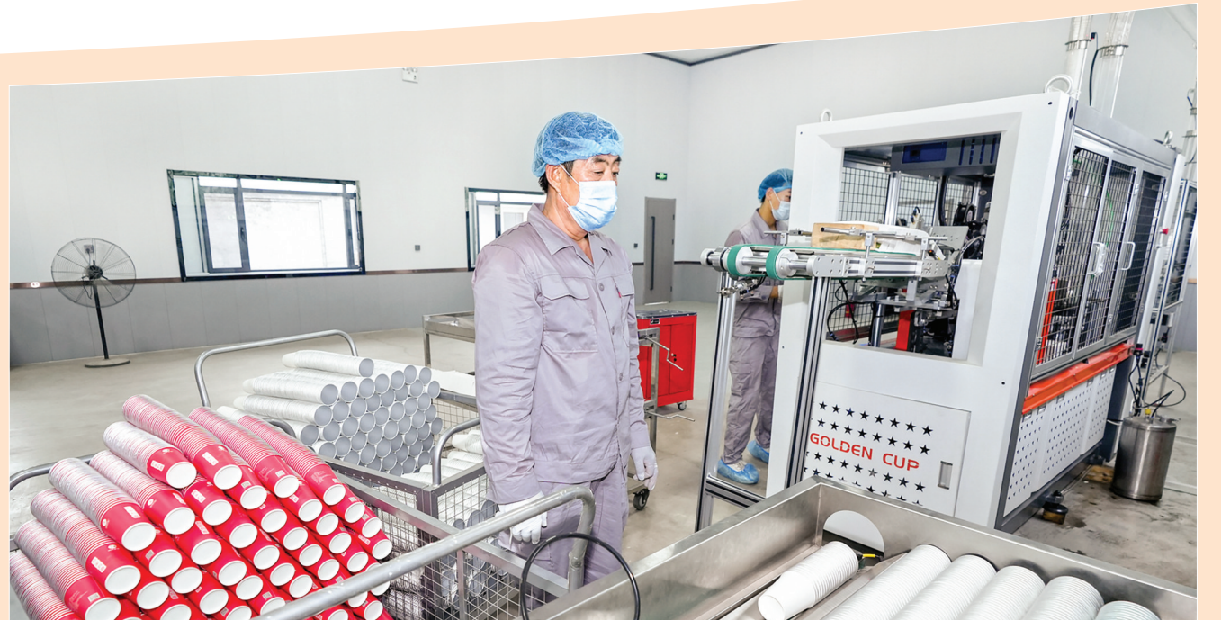
▲三泉镇新和村投资创建长庆印象科技有限公司,注册“长庆印象”品牌,建成年产能一亿个一次性纸杯生产线,满足从纸杯切片、印刷、纸杯成型到内、外包装等全生产流程需求。图为智能化生产线生产一次性铝箔纸杯。
