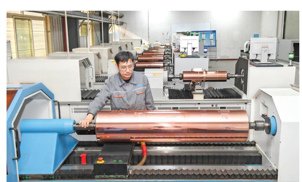
▲12月9日，稷山经济技术开发区印刷包装文化产业园区，运城锐宝制版有限公司工人在加工雕刻版辊。该公司加大技术研发创新力度，引领制版印刷产业从传统的果品包装向塑料包装、医药包装、壁纸等领域能级迈进，年生产各类四印版辊8万支，销往波兰、印度、巴基斯坦等国家，带动了当地包装制版印刷产业高质量发展。
