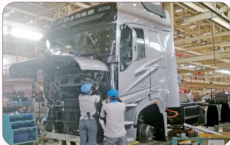
▲总装车间工人在装配氢能源汽车前保险杠 赵茜 摄
