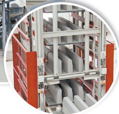
加工好的路沿石 建筑垃圾破碎生产线
