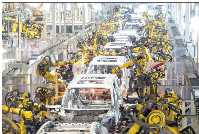
▲4月1日,在位于湖北省武汉市经济技术开发区的岚图汽车电动化焊装车间,机器人在流水线上作业。 新华社记者 肖艺九 摄
