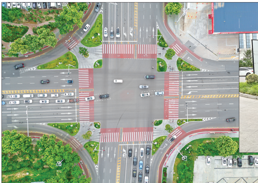
▲学苑路与红旗东街交叉口渠化岛俯瞰图 记者 朱超逸丁 摄
