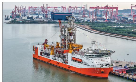
▲2024年11月17日拍摄的靠泊在广州海洋地质调查局科考码头的大洋钻探船“梦想”号。当日,拥有最大11000米的钻深能力,我国自主设计建造的首艘大洋钻探船“梦想”号在广州正式入列,标志着我国深海探测关键技术装备取得重大突破。
