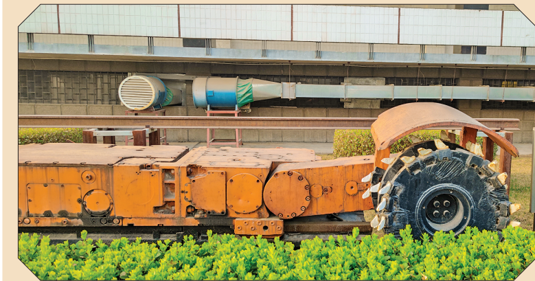
▲中国煤炭博物馆薄煤层采煤机
