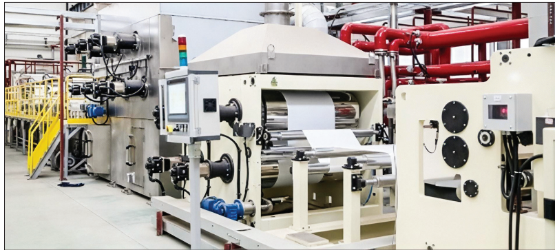
▲锂电池隔膜涂覆中试线
