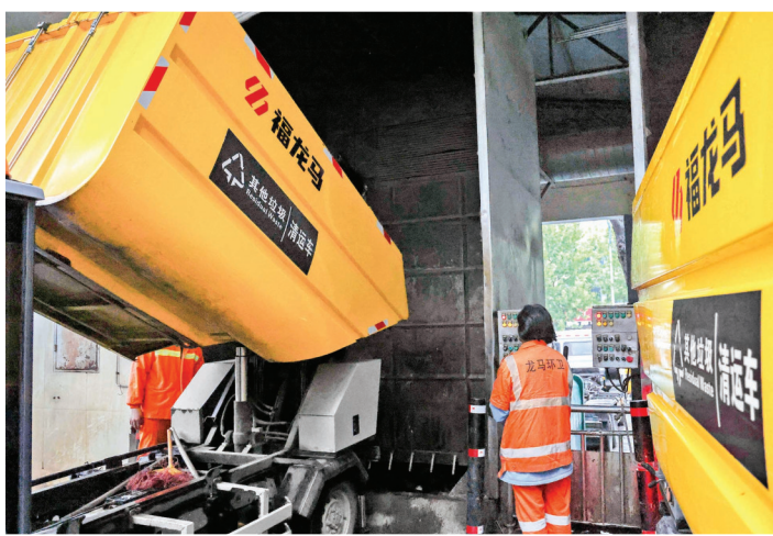
▲生活垃圾在中转站进行压缩处理后，将使用专业的大型转运车辆运送至运城市生活垃圾焚烧发电厂进行处理。
