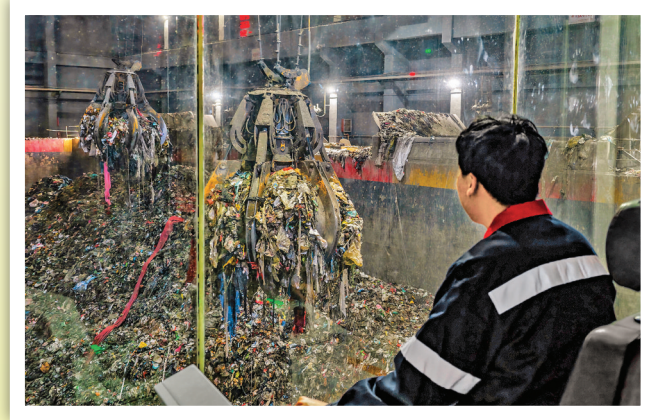
▲运城市生活垃圾焚烧发电厂垃圾处理车间内，工作人员在操作垃圾吊抓斗，将充分发酵的生活垃圾投入焚烧炉。
